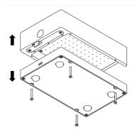
j 为避免损坏仪器顶部和底部之间的刚性插头连接,在拉动过程中,请从背面握住仪器,避免 任何倾斜移动。
