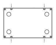
2 小心地将仪器顶部和底部拉开,分开仪器背面的插头连接。
